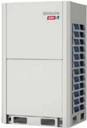
**SDV5 Individual** Außengeräte sind in 11 Leistungsgrößen zwischen 28 und 90kW erhältlich. Mit einer maximalen Rohrlänge von bis zu 1.000m, einem Höhenunterschied zwischen Außen- und Innengeräten von bis zu 110m und Heizen bis -25°C Außentemperatur bieten Ihnen diese Serie eine höchstmögliche Flexibilität- siehe Seite 78
