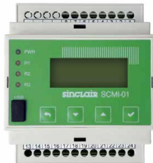
Bei ausgewähltem Arbeitsmodus „Steuerung anhand Temperatur“ wählen Sie eine einstellbare, durch den T2-Temperatursensor (standardmäßig an der Ausgangsluft angebracht) überwachte Zieltemperatur für den Kühlmodus Reg. T\* oder den Heizmodus Reg T+ bzw. den COMBI-Modus (Kühlen und Heizen) in einem Bereich von -10°C bis +60°C
