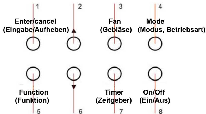
Abb. 3: Tasten an der Kabelbedienung
