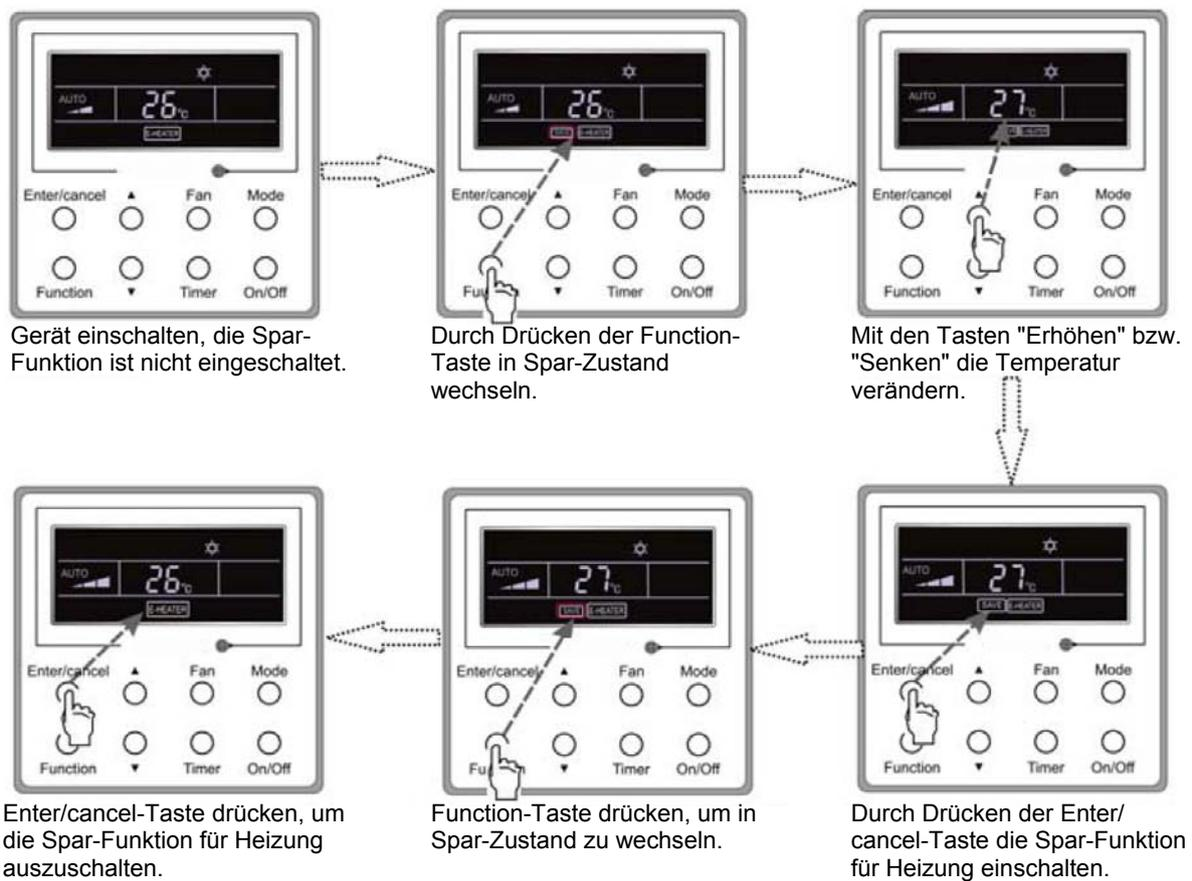
Abb. 16: Sparmodus für Heizung einstellen
