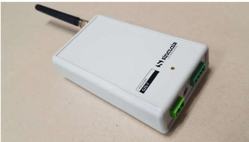
Zum Lieferumfang gehören 230V/50Hz Netzteil mit 12V/1A Ausgangsspannung, zwei 10k $\Omega$  Temperaturfühler ( $\beta=3435$ ), USB-Kabel, CD mit Programmen und Gebrauchsanweisung. Im Modulspeicher können bis zu sechzehn Telefonnummern der Benutzer gespeichert werden; die Benutzer können die angeschlossene Anlage mit ihren Handys steuern, oder sie werden bei Überschreitung der eingestellten Temperaturgrenzen angeklingelt oder durch Alarm-SMS
