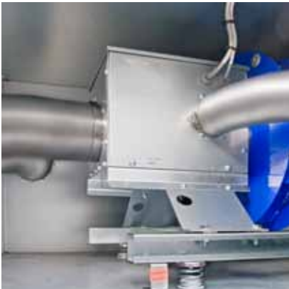
gekapselter Motor mit Fremdbelüftung
