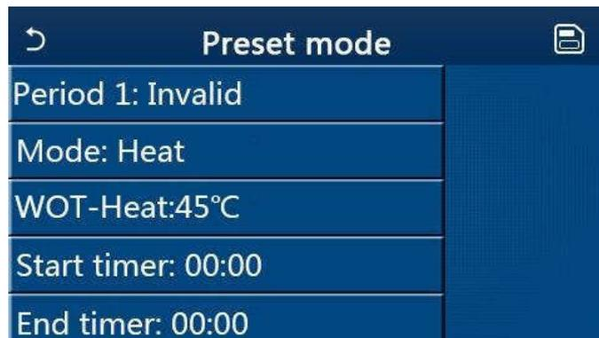
3. Der Parameter „Mode“ (Modus) wird benutzt, um eine Betriebsart voreinzustellen; „WOT-Heat“ (Ausgangswassertemperatur für Heizen) wird benutzt, um die Wassertemperatur vom Kalt-/Warmwasser einzustellen; „Start timer“ (Timer-Startzeit) / „End timer“ (Timer-Endzeit) werden benutzt, um die Zeiten einzustellen. Wird nach erfolgter Einstellung das Icon „Save“ (Speichern) gedrückt, werden alle Einstellungen gespeichert.
