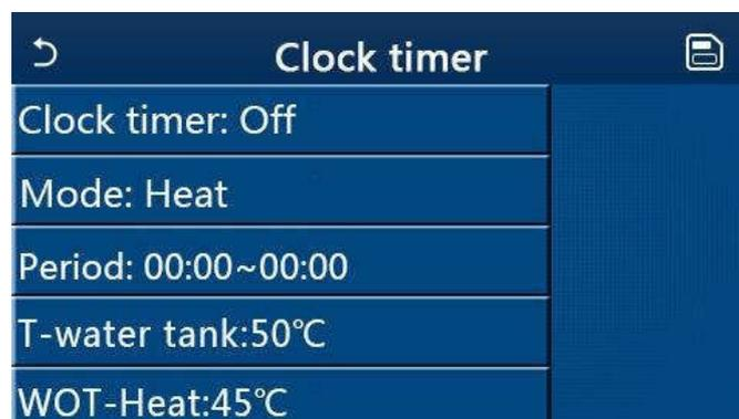
3. Die Option „**Mode**“ (Modus) wird zur Zeitsteuerung des gewünschten Modus benutzt; „**WOT-Heat**“ (Temperatur Ausgangswasser zum Heizen) und „**T-water tank**“ (Temperatur Wasser im Wasserbehälter) werden benutzt, um die entsprechende Wassertemperatur einzustellen; „**Period**“ (Periode) wird benutzt, um einen Zeitabschnitt einzustellen. Wird nach erfolgter Einstellung das Icon „**Save**“ (Speichern) gedrückt, werden alle Einstellungen gespeichert.
