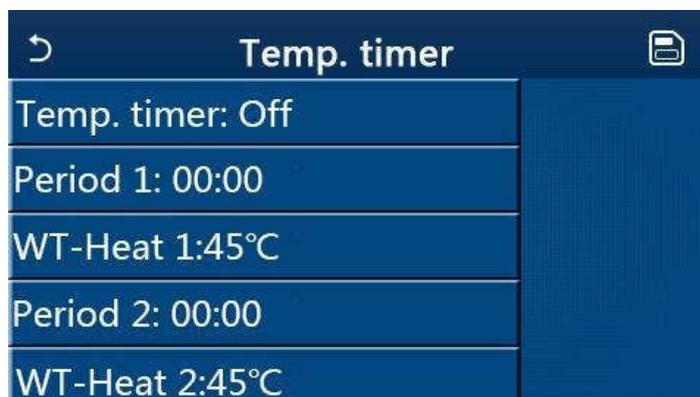
3. Wählen Sie „**Period 1**“ / „**Period 2**“ (Periode 1 / Periode 2) aus; ein Fenster zur Eingabe der Zeitdauer wird angezeigt. Dann wählen Sie „**WT-Heat/WT-Cool 1/2**“ (Wassertemperatur für Kühlen/Heizen 1/2) aus; ein Fenster zur Eingabe der Wassertemperatur wird angezeigt.
