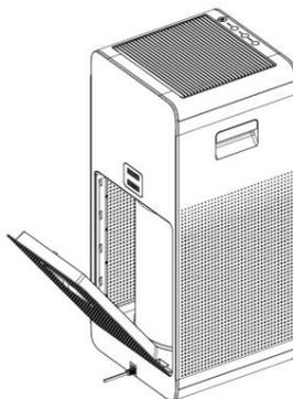
2. Installieren Sie den neuen Filter korrekt orientiert.
