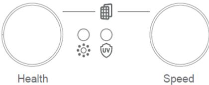
Mit jedem Einschalten des Gerätes setzt der Countdown der Nutzungsdauer der Filter fort. Sobald 2.000 Betriebsstunden erreicht sind, fangen die beiden Leuchtanzeigen „Ionisator“ und „UV-C LED“ an zu blinken, um den notwendigen Filtertausch anzuzeigen. Drücken Sie nach dem Filtertausch die Tasten Health und Speed für 3 Sekunden gleichzeitig, um die Leuchtanzeigen auszuschalten. Die Nutzungsdauer des Filters wird zurückgesetzt, und der Countdown wird neugestartet.
