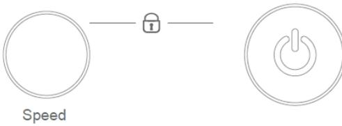
Durch gleichzeitiges Drücken der Tasten Speed und Power für 5 Sekunden können Sie die Funktion Kindersicherung (Bedienung blockieren) aktivieren. Nach einem Signalton werden die anderen Tasten funktionsuntüchtig. Drücken Sie die beiden Tasten für 5 Sekunden gleichzeitig, um die Funktion zu deaktivieren.
